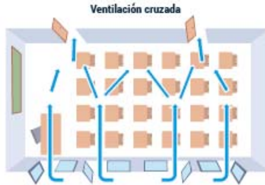
Figura 2.- Ventilación cruzada con puertas y ventanas abiertas.
